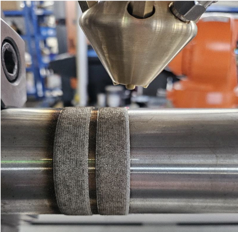
Процесс лазерной наплавки
